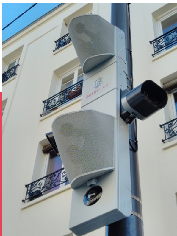
Radar sonore « Hydre » de Bruitparif en cours d'expérimentation rue d'Avron dans le 20 e arrondissement de Paris. Six Franciliens sur dix sont favorables à la généralisation de ce type de dispositif pour verbaliser les véhicules excessivement bruyants.
